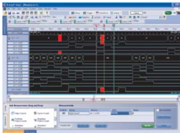
图 8：使用逻辑分析仪进行时序分析
